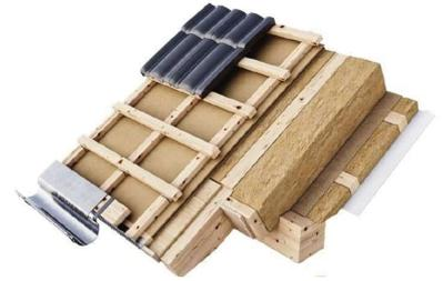
Mehrschaliger Dachaufbau mit hervorragender Dämmqualität gemäß Passivhausstandard, Gesamtdämmstärke 355 mm, U-Gefach = 0,09 W/m<sup>2</sup>K sowie mit hervorragendem sommerlichen Hitzeschutz, Phasenverschiebung 10h.
