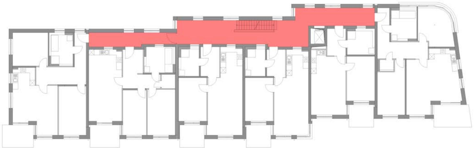
Hinweis: Hoher Schallschutz durch bauliche Berücksichtigung eines innenliegenden Treppenhauses (rote Markierung), sowie Schallschutzfenster in Abgrenzung zur Augsburgener Straße.
