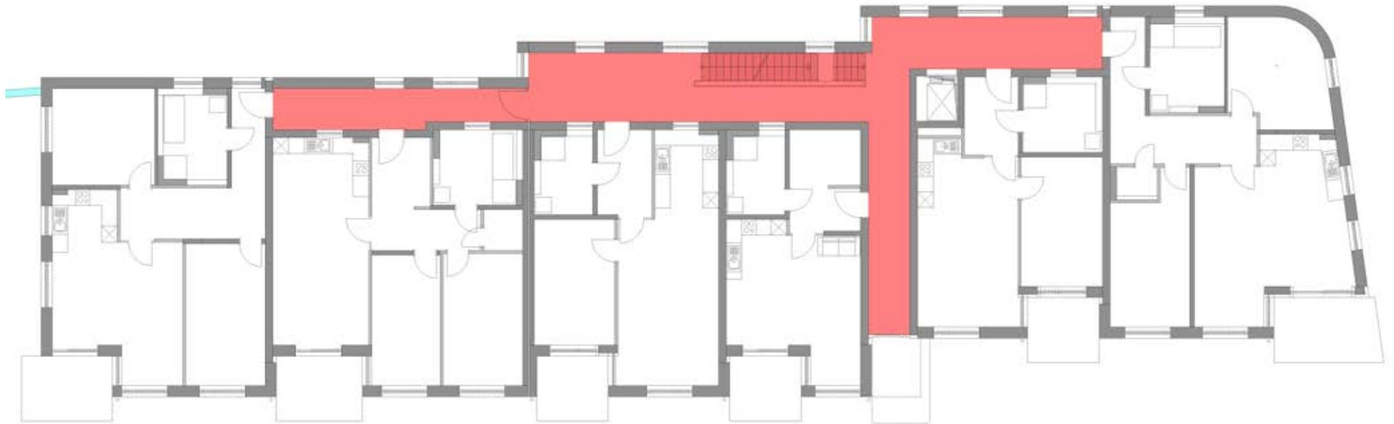
Hinweis: Hoher Schallschutz durch bauliche Berücksichtigung eines innenliegenden Treppenhauses (rote Markierung), sowie Schallschutzfenster in Abgrenzung zur Augsburgur Straße.
