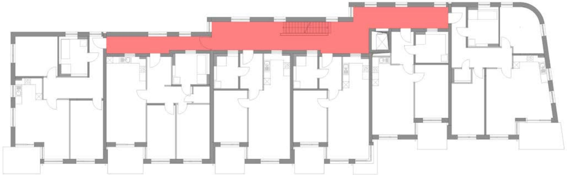
Hinweis: Hoher Schallschutz durch bauliche Berücksichtigung eines innenliegenden Treppenhauses (rote Markierung), sowie Schallschutzfenster in Abgrenzung zur Augsburgur Straße.
